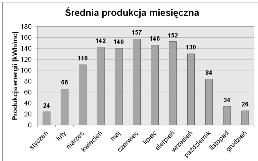
Wykres 17. Produkcja energii elektrycznej przez panele fotowoltaiczne
